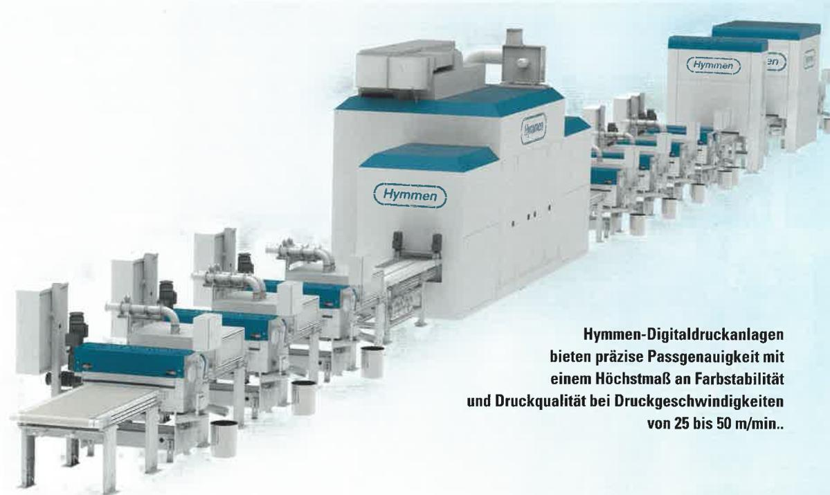
**Hymmen-Digitaldruckanlagen bieten präzise Passgenauigkeit mit einem Höchstmaß an Farbstabilität und Druckqualität bei Druckgeschwindigkeiten von 25 bis 50 m/min..**
